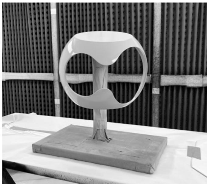
Die finale Form habe ich im CAD gebaut und im Maßstab 1:4 drucken lassen. Bei der Firma „Modellbau Kurz“ habe ich das Produkt lackiert und zu Hause die Polster genäht, die mit Industrie-Klettverschluss in der Schale befestigt werden.
